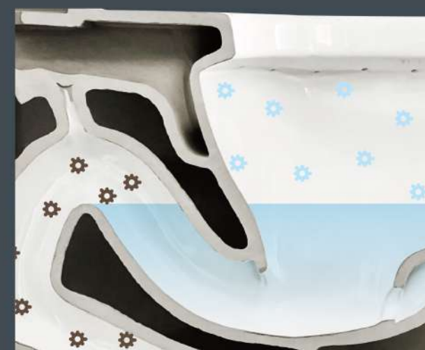
S型管道 S型排汙管道可儲存水封·阻隔排汙管臭氣回流
